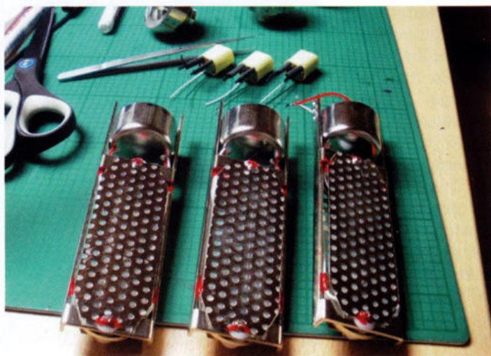
Das Innenleben des Vorgängers LRM-2. Rund acht Bändchenmikrofone werden an einem Tag hergestellt
