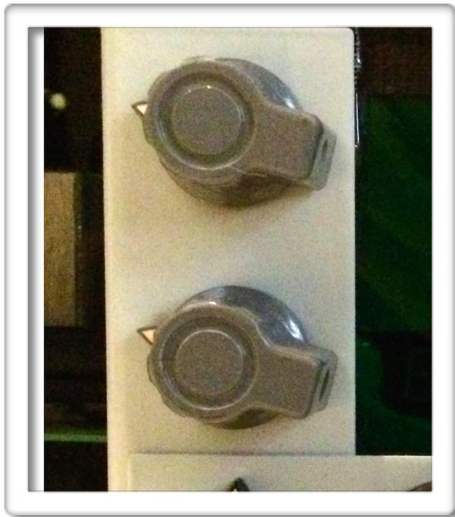
Die Einstellung erfolgt durch die beiden grauen Drehschalter. Der obere für den linken Kanal, der untere für den rechten.
