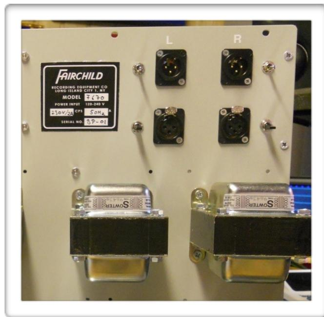
Jede XLR Buchse hat einen Schalter. Die obere Stellung ist „GND-LIFT“
