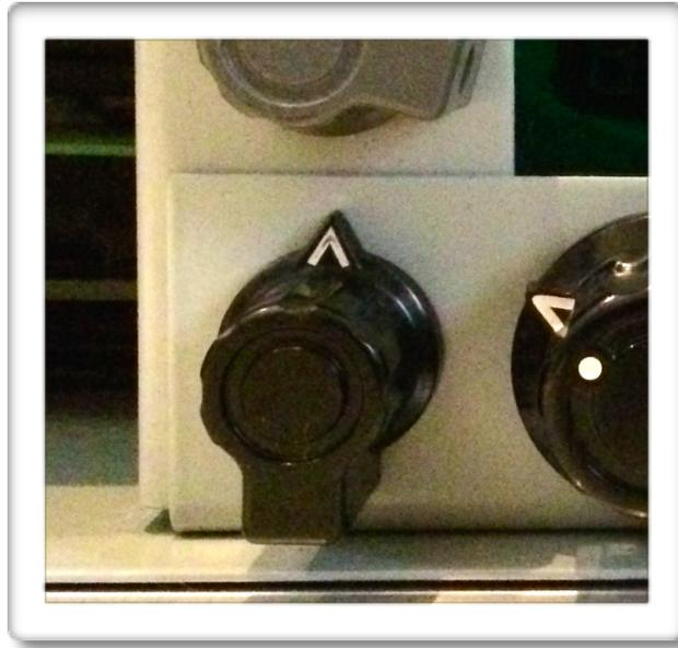
(Bild zeigt die „OFF“ Stellung, On wäre bei 1 Uhr (30° rechts).
